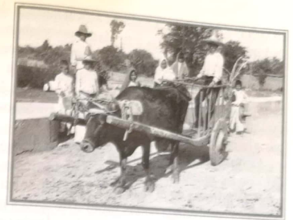
En esta imagen de la carreta es importante resaltar el tipo de rueda que se empleaba. No eran ruedas de rayos cubiertas con hierro. Este tipo de rueda se utilizó mucho en las carretas para acarrear caña durante el periodo colonial. Fototeca del INAH, Pachuca, Hidalgo.
